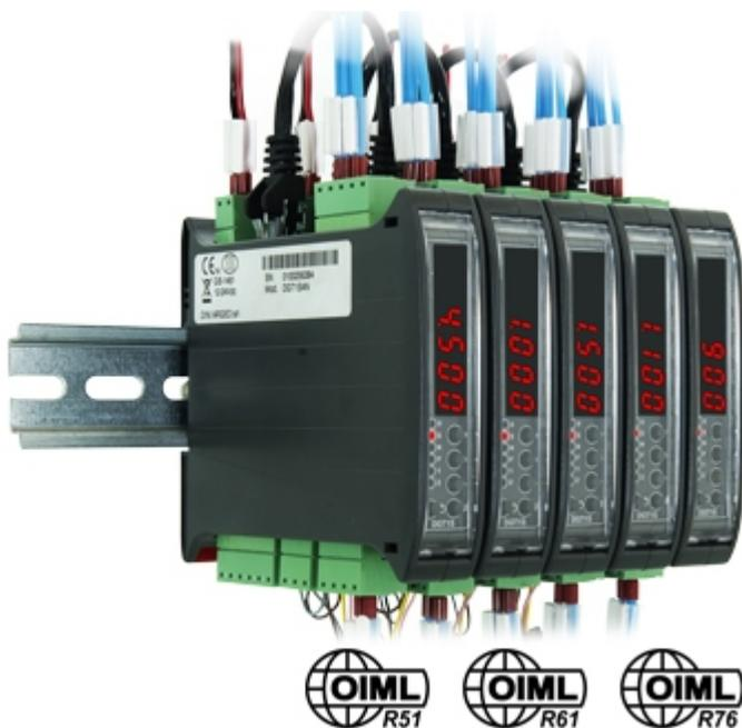
Multifunktionaler Wäge-Indikator zur Hutschienen-Montage. Ermöglicht direkte Abfrage und Diagnose jeder angeschlossenen Waage. Die verfügbaren Schnittstellen ermöglichen die einfache und sichere Integration eines Wägesystems in jedes Automatisierungssystem. CE-M eichfähig (OIML R-76 / EN 45501), MID eichfähig (OIML R-61).
